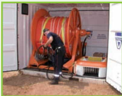
Barrage gonflable sur dévidoir
