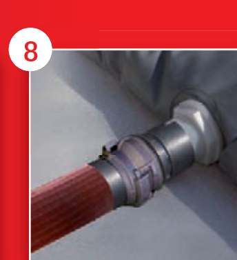
8 Purger la colonne par l'alimentation afin de vider la colonne et le dispositif, puis vider la cuve souple
