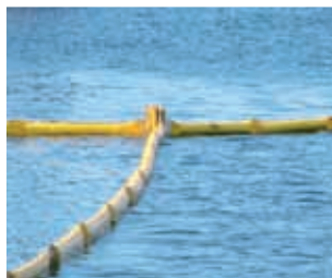
Confinement : barrages flottants
