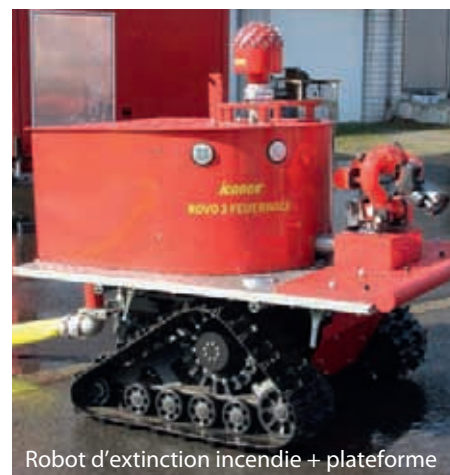
Robot d'extinction incendie + plateforme
